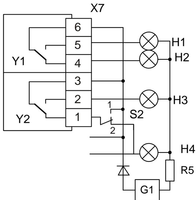
Рисунок Б.3 – Схема подключения при проверке прибора исполнения с электромагнитными реле (остальное – смотри рисунок Б.2)
