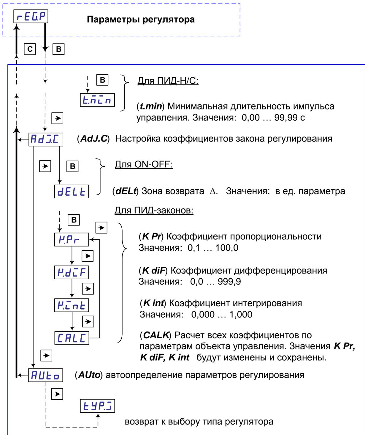
Рисунок 35 – Продолжение схемы задания параметров регулирования.
