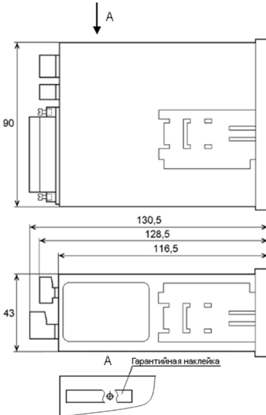
Рисунок А.1 – Габаритный чертеж прибора обычного исполнения.
