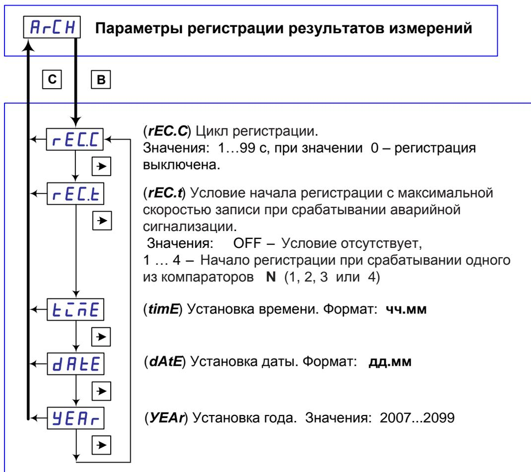
Рисунок 31 – Схема задания параметров регистрации результатов измерений.
