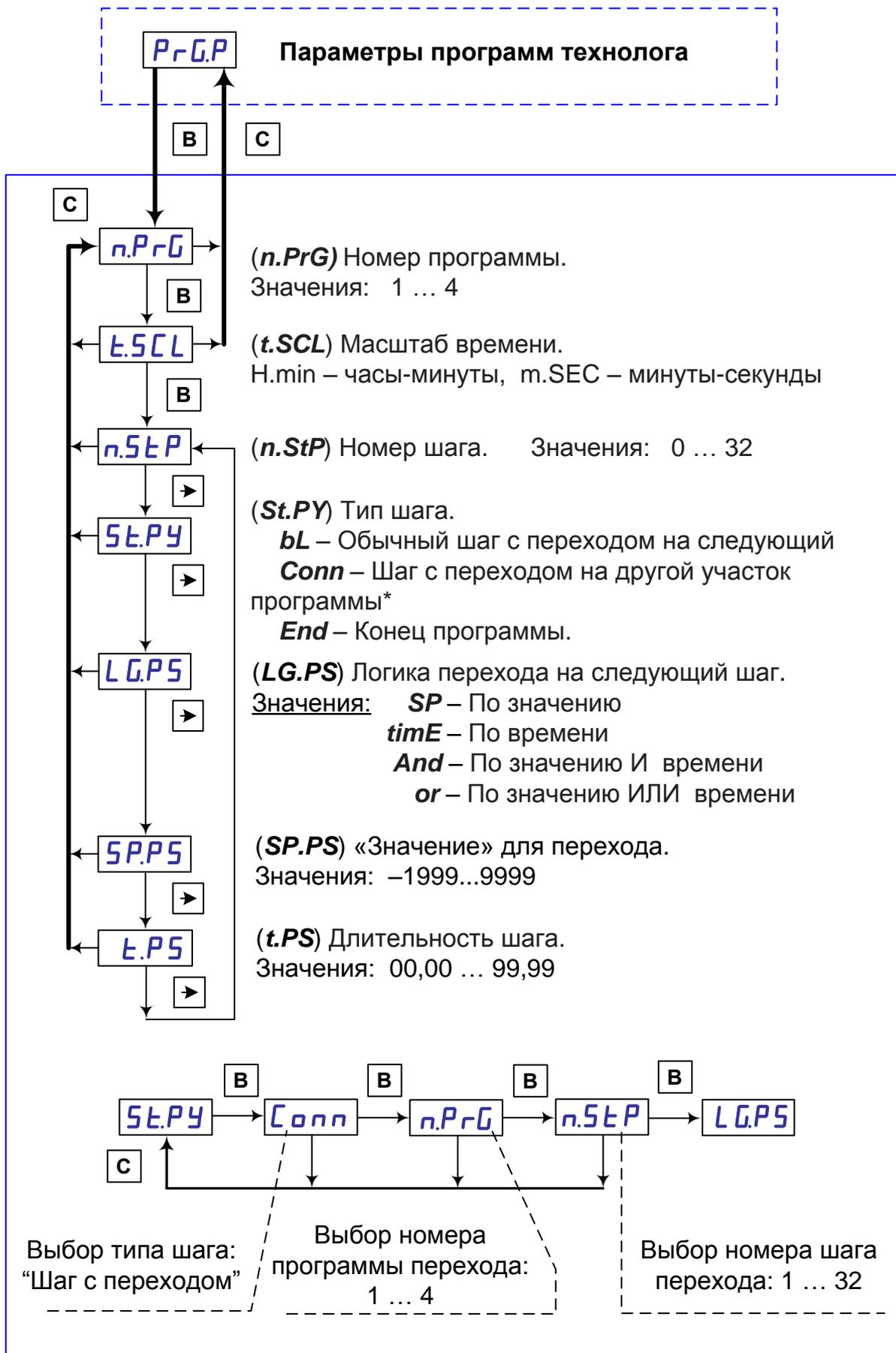
Рисунок 36 – Схема задания параметров программ технолога.
