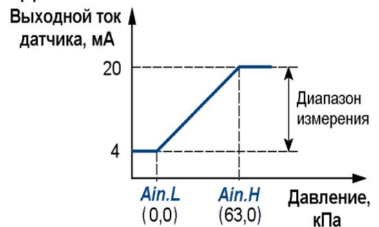
Рисунок 2 – Пример задания диапазона измерения активного датчика
