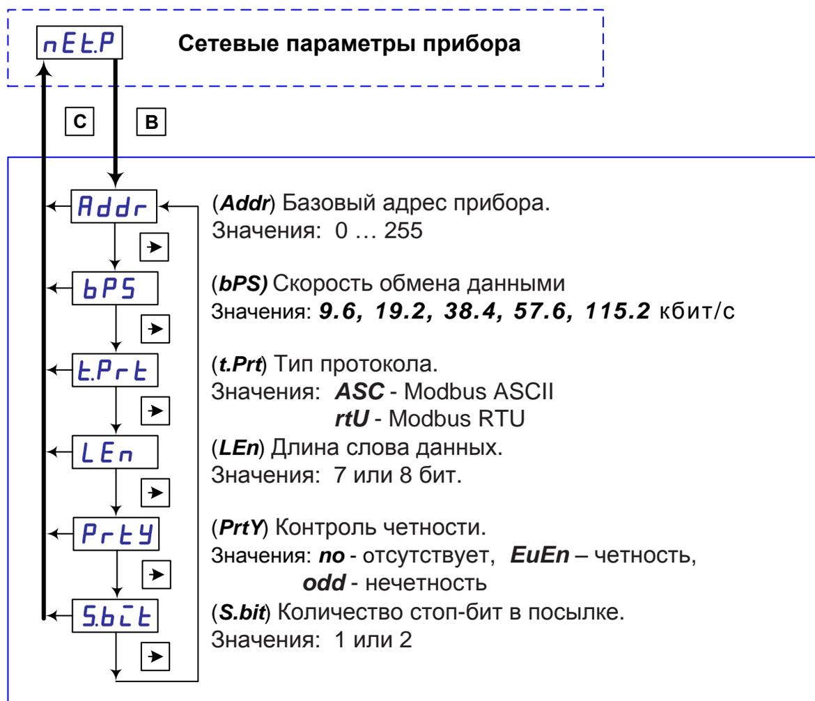
Рисунок 33 – Схема задания сетевых параметров прибора.
