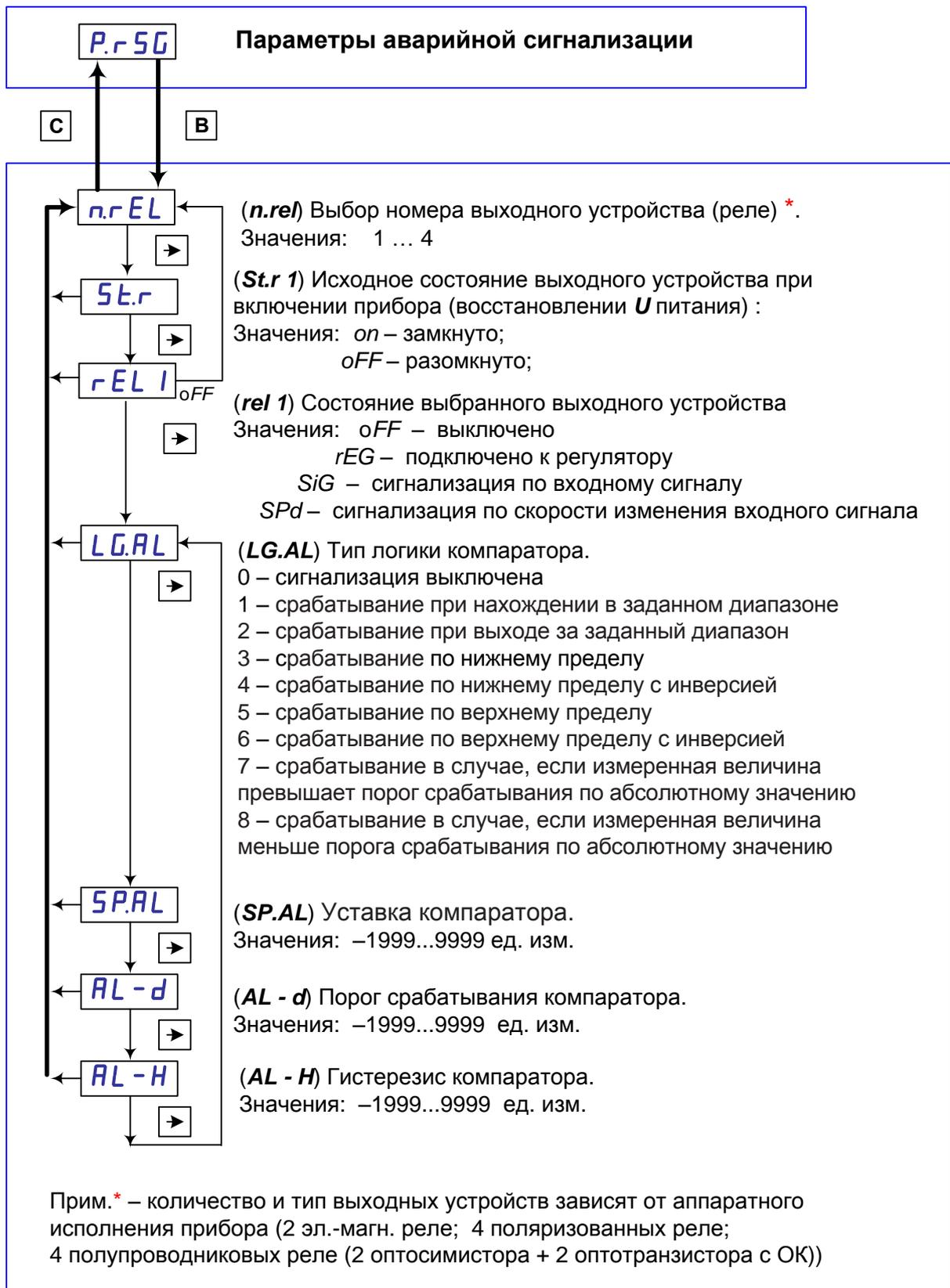
**Рисунок 32 – Схема задания параметров аварийной сигнализации.**
