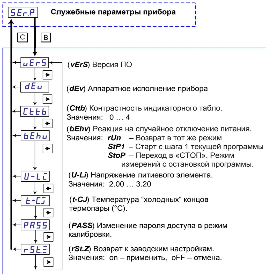
Рисунок 37 – Схема просмотра и задания служебных параметров прибора.
