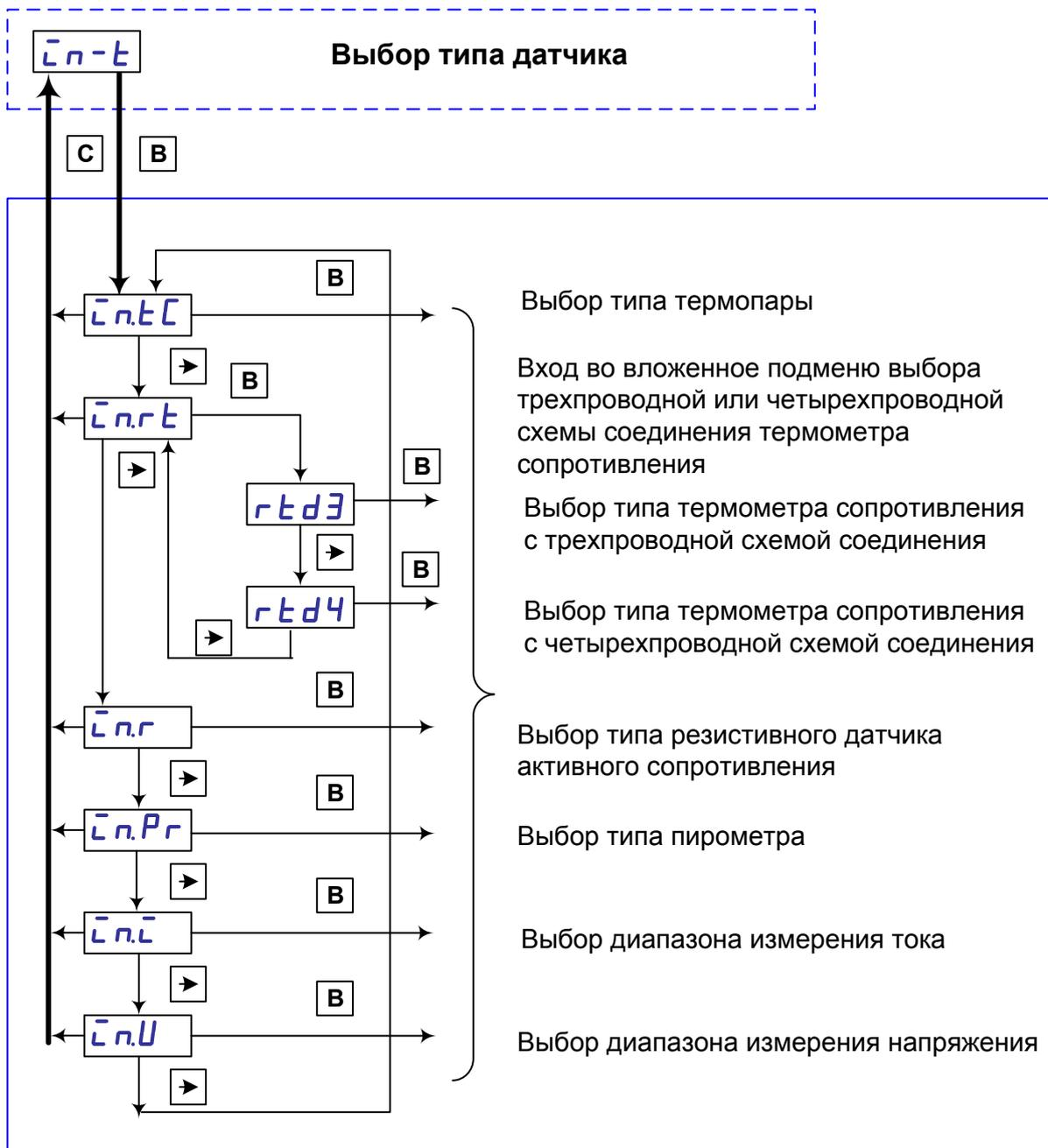
Рисунок 29 – Схема выбора типа входного датчика.
