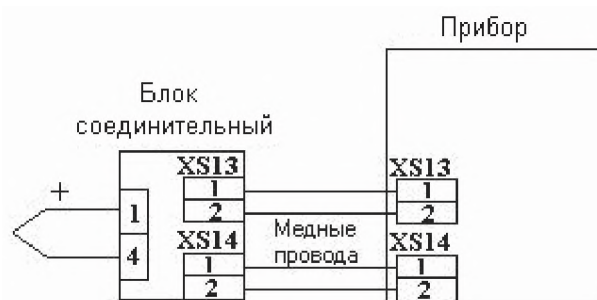
Рисунок 4 – Схема подключения термопары через узел внешней термокомпенсации («Блок соединительный»)
