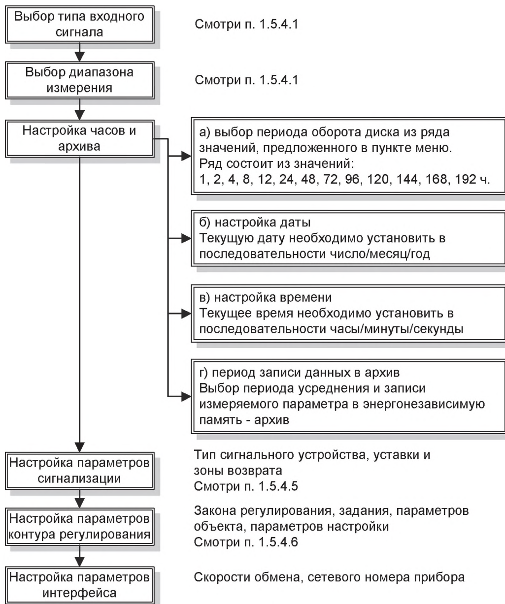
Рисунок 6 – Этапы настройки прибора
