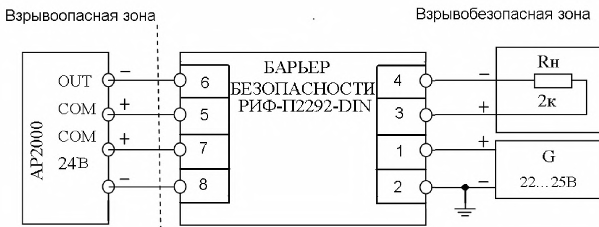
Рисунок Ж.19 – Схема подключения ПВТ (АР2000) и барьера безопасности РИФ-П2292-DIN
