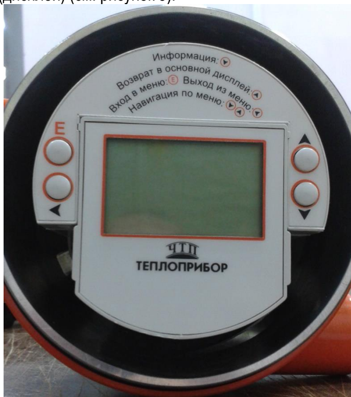
Рисунок 5 - Блок электроники с установленным дисплеем.
