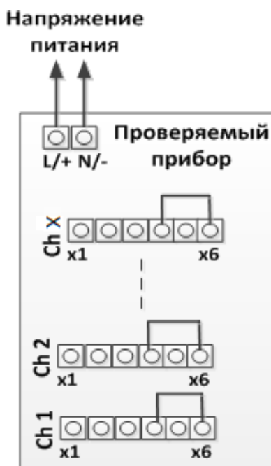
Рисунок Г.4 – Схема подключения для проверки компенсации температуры холодного спая
