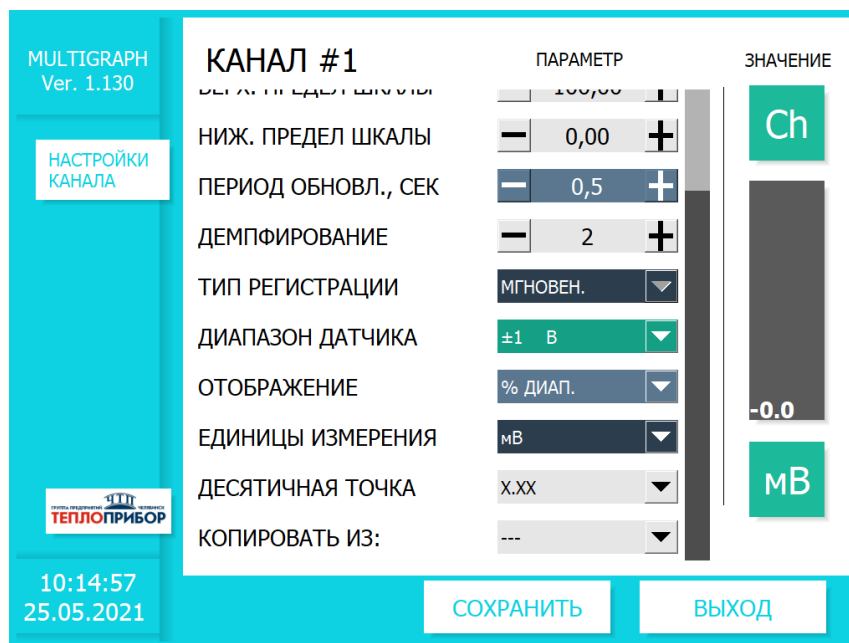
Рисунок 2.19 – Настройка единиц измерения в режиме напряжения
