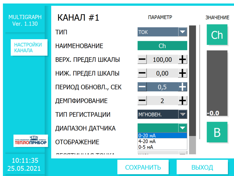
Рисунок 2.15 – Параметры настройки входа токового сигнала
