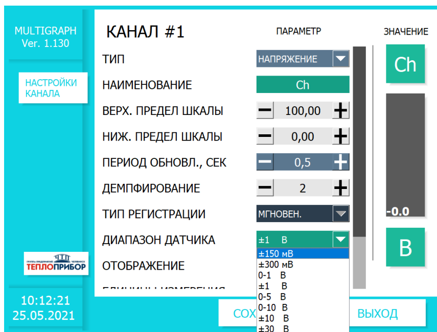
Рисунок 2.16 – Параметры настройки входа измерения напряжения
